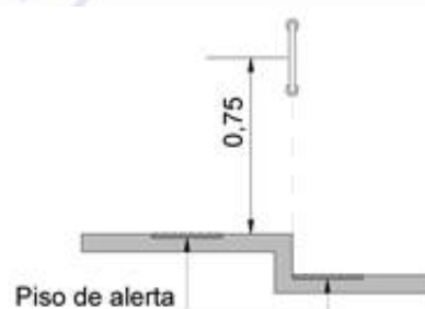
b) Barra de apoio vertical
