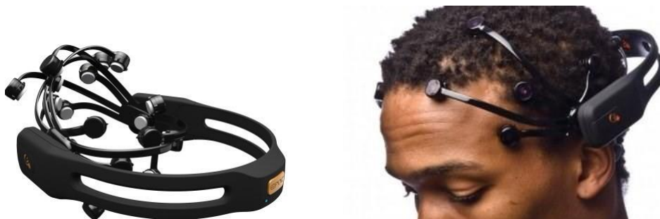
Figura 2- Disposição dos eletrodos alinhados de acordo com a disposição internacional de análise eletroencefalográfica em sistema 10-20 de posicionamento. Fonte: Emotiv Epoc User Manual .
